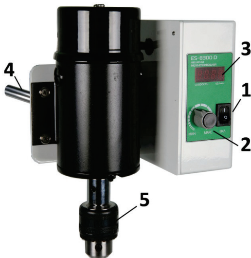
Рисунок 1 - Перемешивающее устройство ES-8300D 1 – сетевой выключатель, 2 – регулятор скорости, 3 – индикатор скорости, 4 – шток, 5 – патрон.
