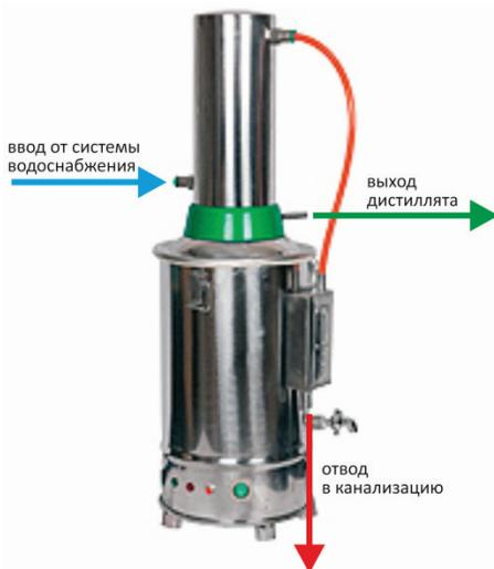
**Рисунок 3 – Схема подключения дистиллятора**
